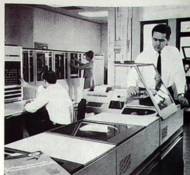
Großrechenanlage der Arbeitsgemeinschaft DVL-RIB in Stuttgart. Die Zentraleinheit „4004/55“ (links) ist das größte und leistungsfähigste Modell des Siemens-Systems „4004“. Die Anlage ist mit 2 Magnetband-Zwillingen, Bedienungsgeräten, mit Blattschreiber (Mitte), 4 Magnetplattenspeichern (im Vordergrund) und Schnelldrucker (rechts hinten) ausgestattet
