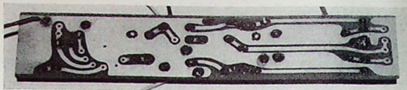
Bild 5. Lötseite der gedruckten Schaltungsplatte (Stereo-Ausführung)
